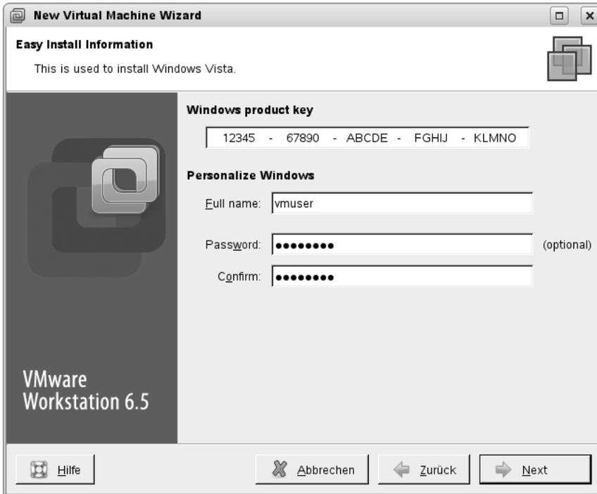
Abbildung 19.8: Easy Install von VMware Workstation
