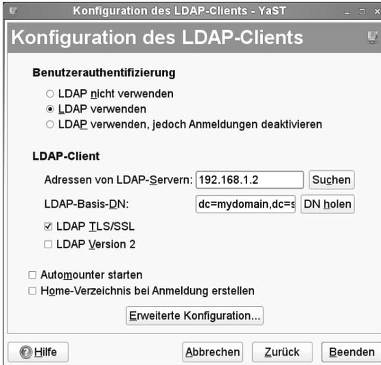
Abbildung 3.33: Konfiguration eines entfernten LDAP-Servers
