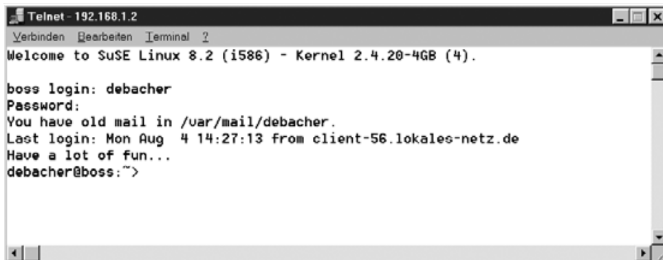
Abbildung 5.10: Telnet vom Windows-PC auf einen Linux-Server
