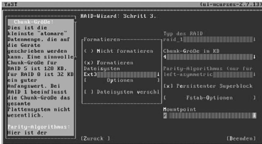
Abbildung 2.21: Raid-Array formatieren
